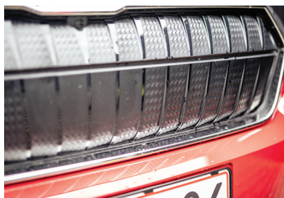
De tre fotos viser forskellige former for identifikation af en EV – logo, manglende kølergitter, manglende udstødning. Foto: Beredskabsstyrelsen
