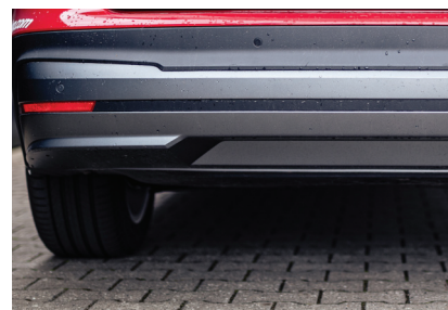
De tre fotos viser forskellige former for identifikation af en EV – logo, manglende kølergitter, manglende udstødning. Foto: Beredskabsstyrelsen
