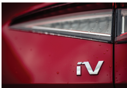
De tre fotos viser forskellige former for identifikation af en EV – logo, manglende kølergitter, manglende udstødning. Foto: Beredskabsstyrelsen
