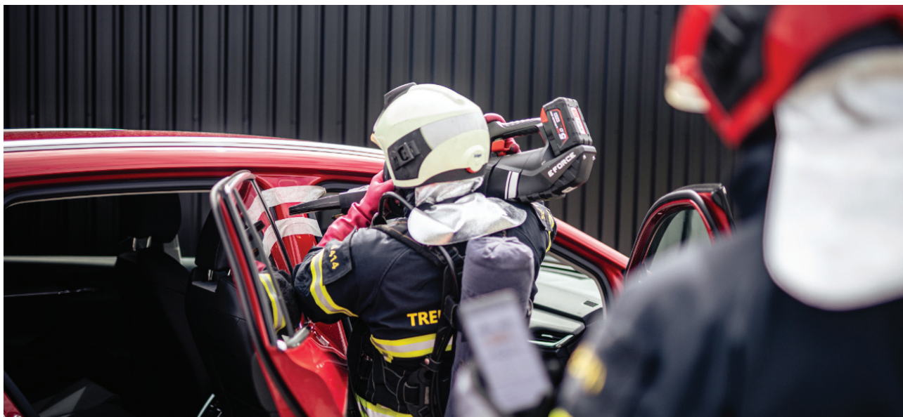
Den tekniske leder markerer placering af klip på elbilen Foto: Beredskabsstyrelsen
