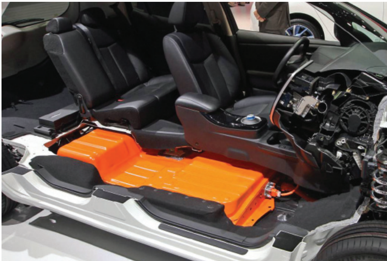
Batteriramme integreret under sæder i kabinen. Foto: Toyota
