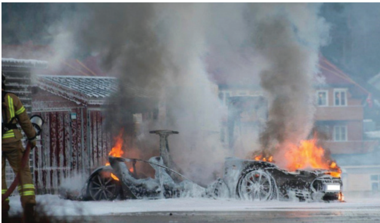
Ved en brand i en Tesla under opladning den 1. januar 2016 i Brokelandsheia i Norge udbrød der brand i elbilens højvoltsbatteri. Branden varede 23 timer og bilen endte med at være helt udbrændt. Efter slukningsindsatsen var overstået, var der fortsat 400 V højspænding i ca. 1/4 af batteriet. Foto: Østre Agder Brannvesen
