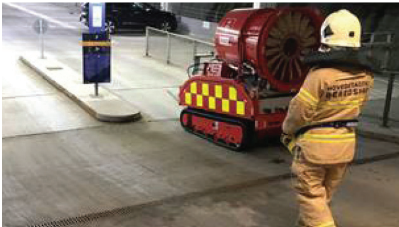
Anvendelse af LUF 60, til henholdsvis ventilering og bugsering af elbil fra P-kælder eller parkeringshus Foto: Hovedstadens Beredskab
