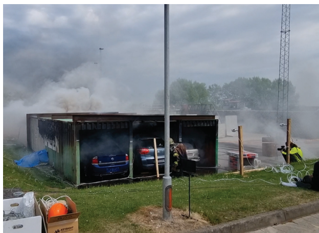
Foto 2: Branden i batteripakken er kraftig tiltagende og brandspredning til kabinen er startet.
