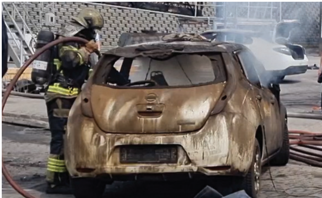
Køling af batteri i ELBAS projektet, 2022 Foto: Beredskabsstyrelsen
