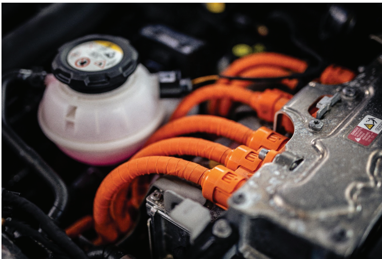
Kabler med høj spænding vil oftest være orangefarvede, som her i motorrummet Foto: Beredskabsstyrelsen
